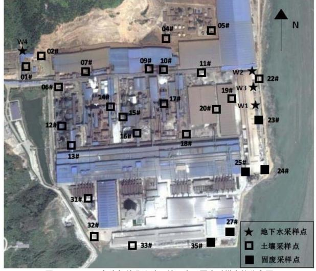
图 3.1-1 2018 年青拓镍业土壤、地下水及固废采样点位分布图
